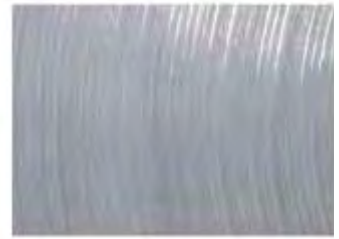
N8 R a 3,2 μm – AARH / CL 125 R t 12,5 μm
