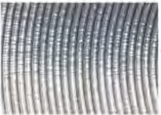
N10 R a 12,5 μm – AARH / CL 500 R t 48,7 μm
