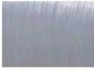
N6 R a 0,8 μm – AARH / CL 32 R t 3,20 μm
