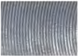
N9 R a 6,3 μm – AARH / CL 250 R t 25,7 μm
