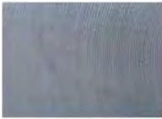
N5 R a 0,4 μm – AARH / CL 16 R t 1,92 μm
